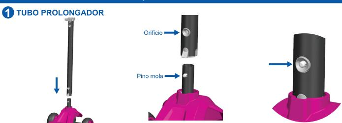
1.1 - Inserir a extremidade do tubo prolongador no quadro, alinhando e encaixando o pino mola do quadro no orifício do tubo. Verificar se as peças estão corretamente encaixadas.
