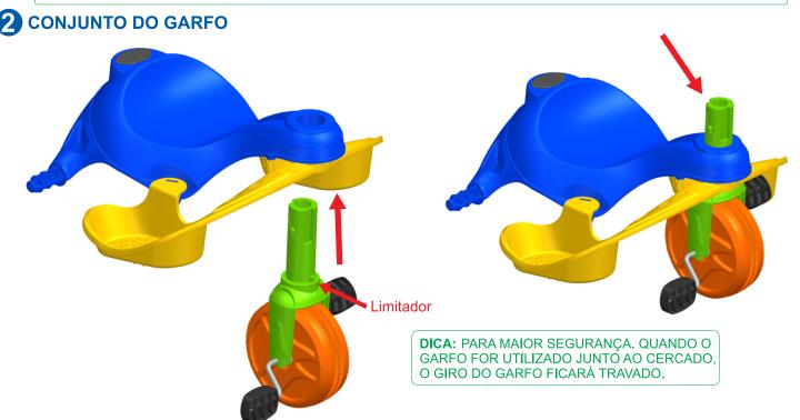
**2.1 -** Posicione o conjunto do garfo na área inferior do corpo e posicione o limitador do garfo voltado para frente.
