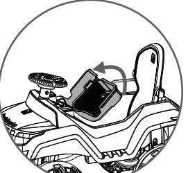
2.1 - Para remover o assento, pressione as duas travas localizadas na parte interna do produto, utilize a aba auxiliar para mover o item.
