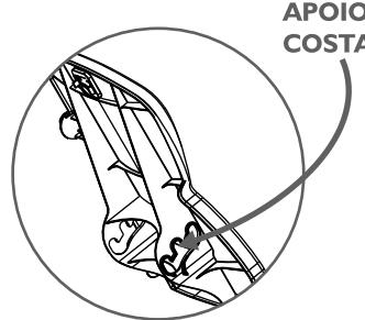
1.1 - O apoio de costas possui 3(três) posições de inclinação. Puxe o apoio de costas para cima, incline-o para efetuar o encaixe na posição desejada.
