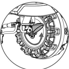
3.1 - Pressione o pedal do freio posicionando-o para baixo para frear o produto. Para colocar em movimento faça a operação inversa, posicionando o pedal do freio para cima.
