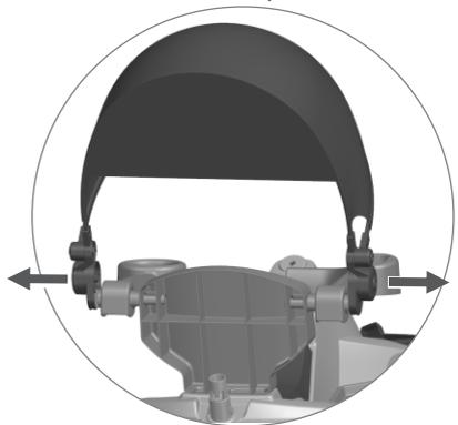
9.1 - A capota é articulável, retrátil e removível. Para articular, mantenha a capota encaixada no suporte, Segure os dois suportes da capota, puxe para fora (**conforme ilustração**) e articule lentamente.
