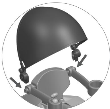
9.0 - Insira e encaixe a capota no suporte localizado nas laterais do apoio de costas e pressione até a total fixação .
