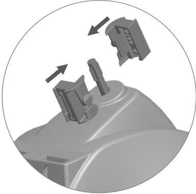
3.2 - Encaixe as duas peças do soquete nas travas do eixo.
