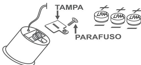
8.0 - Utilizando uma chave de Fenda (não inclusa), remova o chip sonoro do guidão. **Remova o chip sonoro com cuidado, para não romper os fios do LED.**
