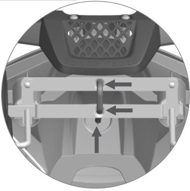
3.0 - Verifique o correto encaixe do eixo de direção na área inferior da carroceria.
