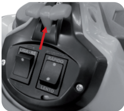
Alavanca para a frente: marcha à frente.
