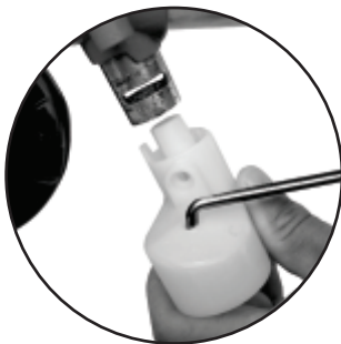
2 -Retirar o direcionador que está fixado no quadro e encaixe a outra ponta da haste do eixo.
