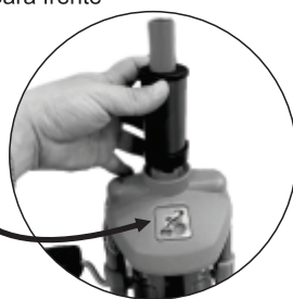
3 - Inserir o conjunto do garfo passando pelas buchas.
