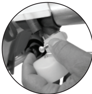
3- Encaixe novamente o direcionador no quadro e fixe com o parafuso e porca .
