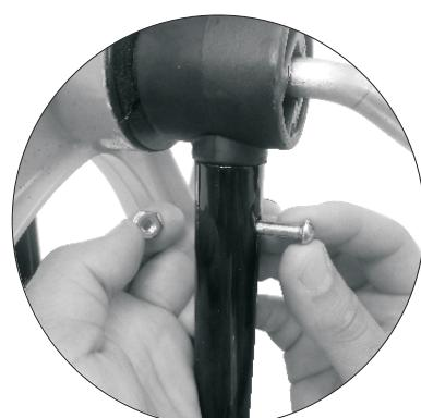
1.5- Coloque o parafuso e a porca no furo do tubo do garfo.
