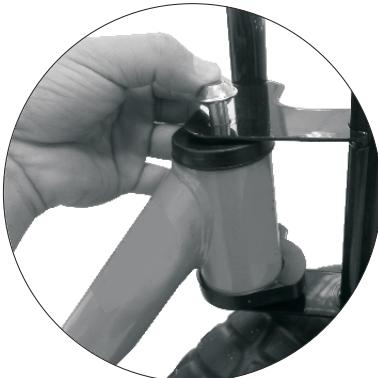
**1.11-** Alinhe os furos e coloque o eixo do cachimbo.
