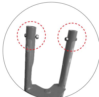
1.2- Remova os parafusos e as porcas do garfo/guidão e guarde-os.
