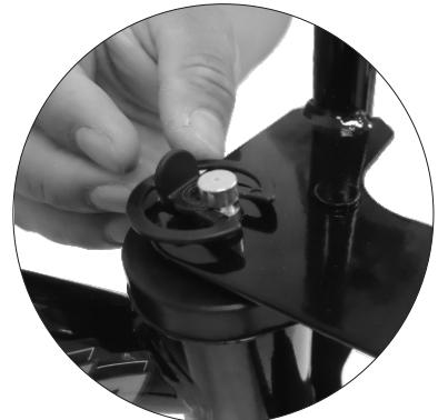
**1.12-** Para finalizar a fixação do garfo, coloque a trava plástica na extremidade inferior do eixo do cachimbo até que esteja totalmente encaixada.
