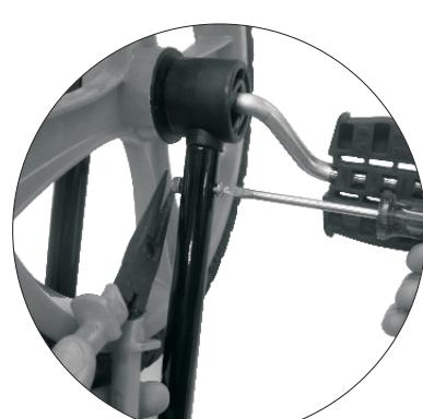
1.6- Use um alicate (não incluído) para segurar a porca e aperte o parafuso com uma chave Phillips (não incluída). Repita o processo do outro lado do tubo.
