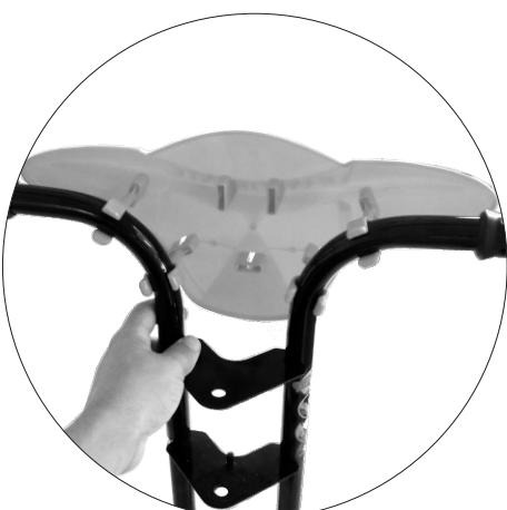
**3.1-** Coloque a carenagem na frente do guidão e pressione para encaixar.
