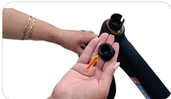
**1.2** Com uma chave Philips ou de fenda (**não inclusa**), remova a tampa de proteção do tubo do quadro e descarte-a em local adequado e fora do alcance de crianças.
