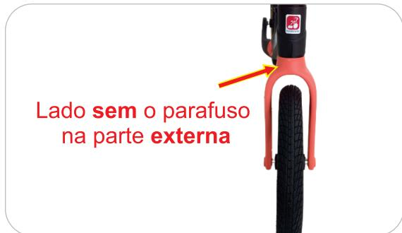
**1.5** Posicione e alinhe o garfo, observando que o lado que contém o parafuso deverá ficar voltado para a parte interna do produto.
