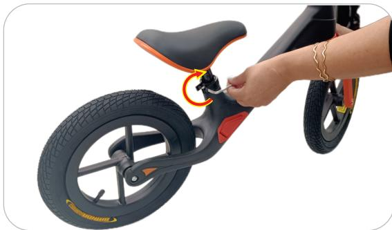
**2.1** Posicione o selim na altura desejada e, com uma chave Allen de 5 mm, aperte o parafuso da abraçadeira girando no sentido horário. Certifique-se de que o parafuso esteja totalmente apertado.
