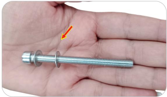
**1.6** Remova o parafuso e as arruelas do guidão e reserve-os para a posterior fixação do guidão.
