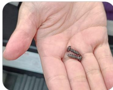
**1.0** Remova a abraçadeira plástica que prende a alavanca e descarte-a em um local adequado. Retire os dois parafusos e guarde-os para a montagem da alavanca.
