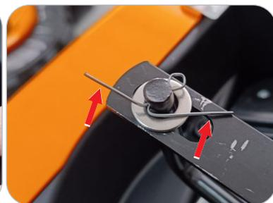
**1.9** Insira novamente a arruela no eixo, coloque a cupilha, encaixando as duas extremidades no furo do eixo, e dobre ambas as extremidades da cupilha para mantê-la fixa.
