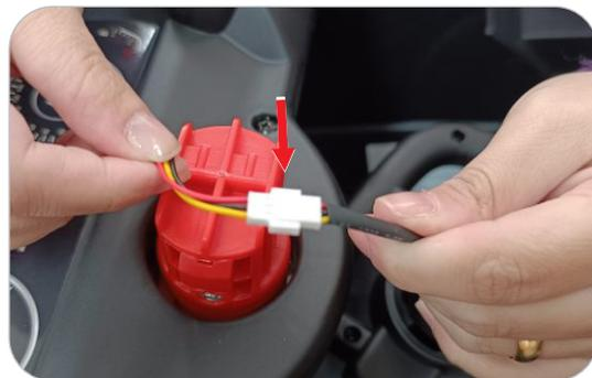
**1.0** Remova a fita adesiva que prende o plug do corpo. Pegue o volante e conecte o plug do volante ao plug do corpo.
