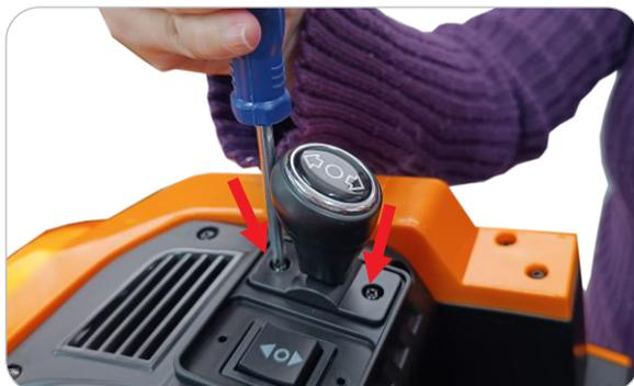
**1.2** Pressione para encaixar e fixe com os parafusos.
