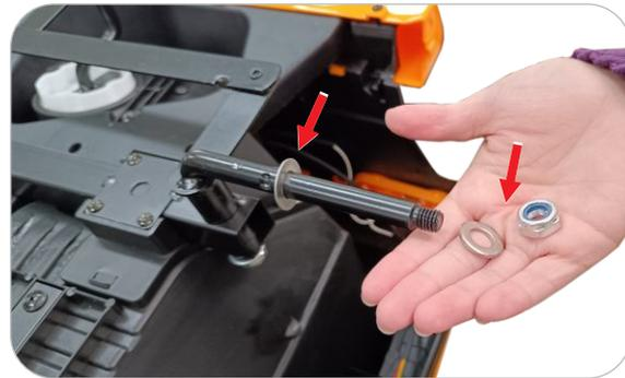
**1.0** Com uma chave plástica, remova a porca e uma arruela do eixo. Reserve-as para montagem posterior e mantenha a outra arruela encaixada no eixo.
