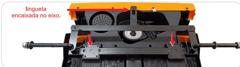
**1.7** Encaixe o conjunto de direção na carroceria e insira a lingueta no eixo de direção.
