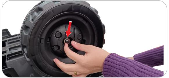
**1.3** Insira uma roda em cada lado do eixo e encaixe-as no mecanismo. Em seguida, insira uma arruela em cada roda.
