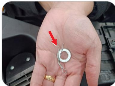
**1.5** Remova a cupilha e a arruela do eixo de direção e reserve-os para finalizar a montagem do conjunto de direção.
