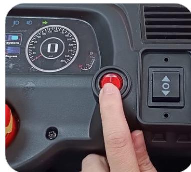
**1.0** Retire a tampa plástica do **terminal vermelho da bateria**. Conecte o conector no **terminal vermelho (+)** da bateria. Ligue o produto para certificar-se de que a conexão está correta.
