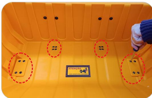
**1.2** Pegue 16 parafusos do kit e certifique-se de que cada furo esteja alinhado e todos os componentes encaixados. Fixe-os com os parafusos.
