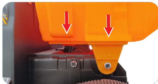
**1.1** Posicione a caçamba na parte traseira da carroceria, encaixando-a nos dois mancais e nas duas hastes de acionamento.
