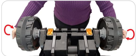
**1.4** Insira uma porca em cada lado da roda. Pegue as duas chaves plásticas e aperte as porcas simultaneamente.
