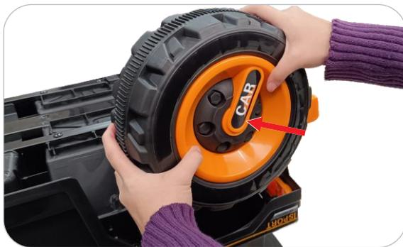
**1.3** Pegue a calota e a posicione de forma que as suas travas fiquem coincidentes e alinhadas aos alojamentos da roda e pressione para encaixar. Repita as etapas para a montagem da outra roda.
