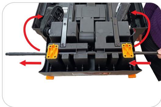
**1.1** Remova as abraçadeiras e o elástico que prendem os mecanismos e descarte-os em um local apropriado. Afaste os mecanismos para possibilitar a inserção do eixo e insira o eixo na carroceria, passando pelos furos.
