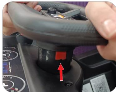
**1.1** Posicione os fios no alojamento da carroceria, a fim de não ficarem expostos. Em seguida, encaixe o volante no suporte e pressione até que a trava encaixe no alojamento do volante.
