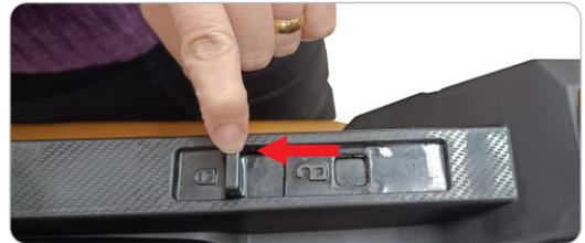
Conforme mostrado na imagem, pressione o botão e deslize a trava para a posição indicada para que o movimento pela alavanca seja inibido.
