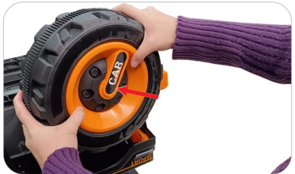
**1.5** Pegue a calota e a posicione de forma que as suas travas fiquem coincidentes e alinhadas aos alojamentos da roda. Pressione para encaixar. Repita o processo para a montagem da calota na outra roda.
