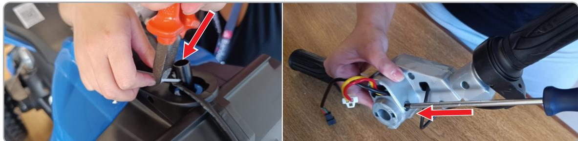
**1.1** Posicione a carroceria em sua posição normal de uso. Remova a abraçadeira plástica que segura os fios. Utilize uma chave philips (não inclusa) para retirar o parafuso e a porca, guardando-os para uso posterior.
