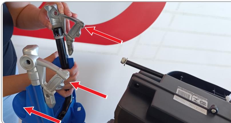
**1.7** mantenha a parte maior do para-lama voltada para a frente e encaixe os protetores no garfo, posicionando conforme a ilustração.
