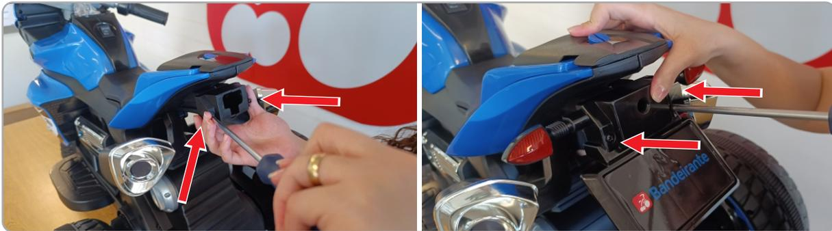
**1.0** Remova os dois parafusos da carroceria, insira a placa traseira, alinhe os furos, insira novamente os parafusos e fixe-os com uma chave philips.
