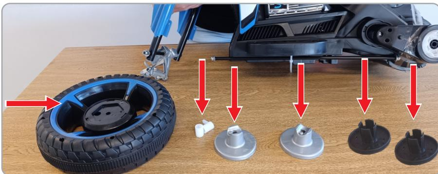
**1.2** Separe a roda dianteira, as duas chaves plásticas, as duas buchas prata e as duas buchas preta para a montagem da roda dianteira.
