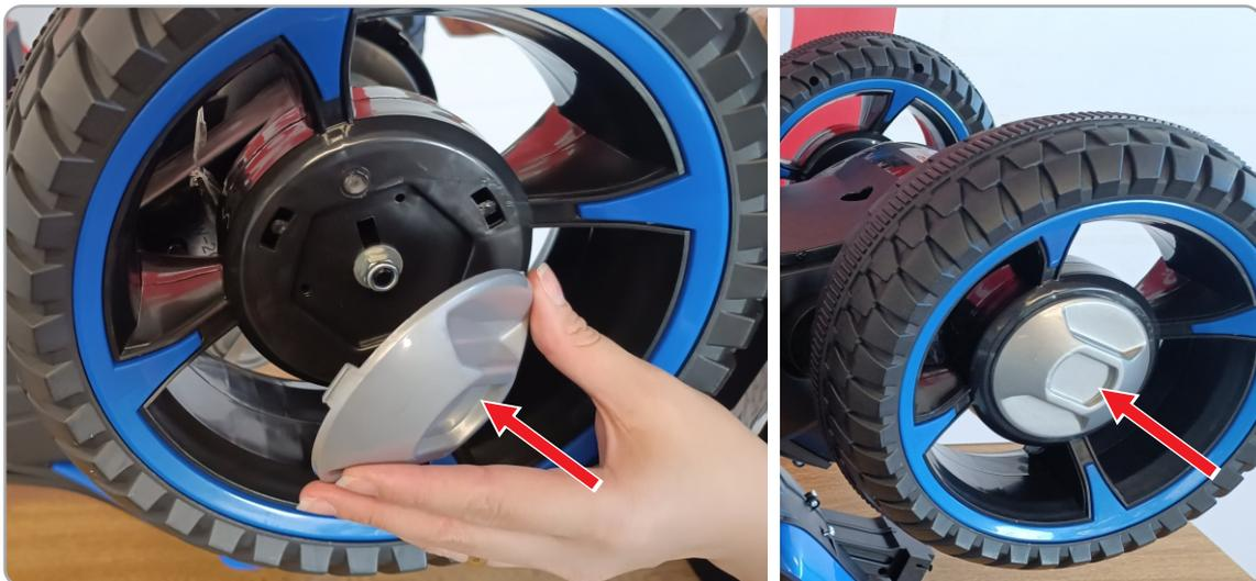
**1.4** coloque uma calota em cada roda, alinhando as travas com os alojamentos e pressione para fixá-la.
