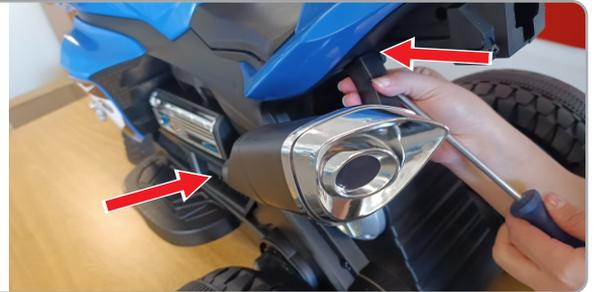
**1.1** Encaixe e pressione a trava do escapamento no alojamento lateral da carroceria, e fixe a outra extremidade com o parafuso na carroceria, no mesmo local onde foi removido o parafuso.
