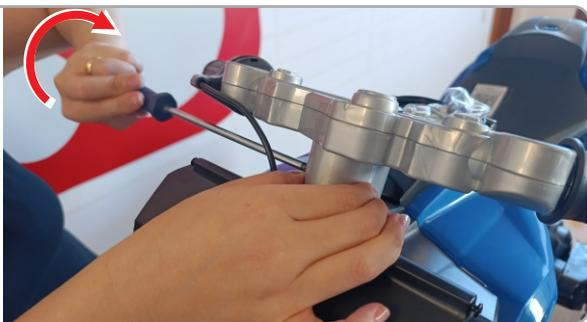
**1.3** Encaixe o guidão no corpo, alinhe os furos, insira o parafuso e a porca e fixe com uma chave philips.
