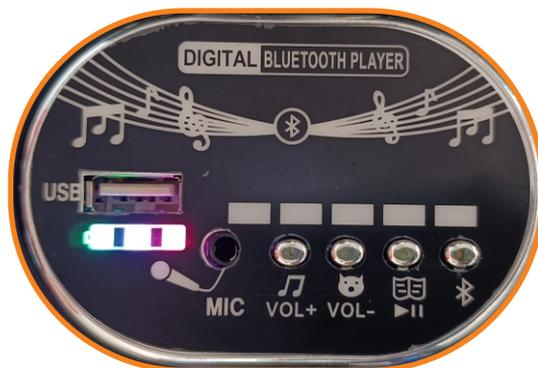
O painel multimídia conta com sistema Bluetooth, entrada USB, seletor de música, controle de volume e indicador de bateria.
