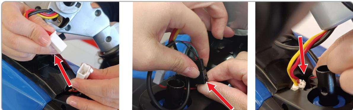
**1.2** Conecte os plugs do guidão aos plugs do corpo. Posicione os fios nos alojamentos da carroceria de forma que não fiquem expostos nem esmagados.
