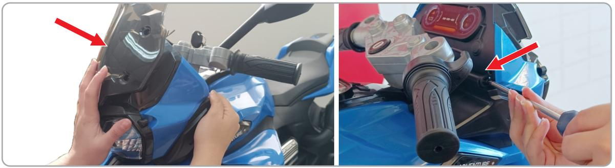
**1.2** Encaixe a carenagem na carroceria e pressione para encaixar a carenagem na trava do corpo. Alinhe os furos laterais e insira novamente os parafusos no lado direito e esquerdo para fixar a carenagem.
