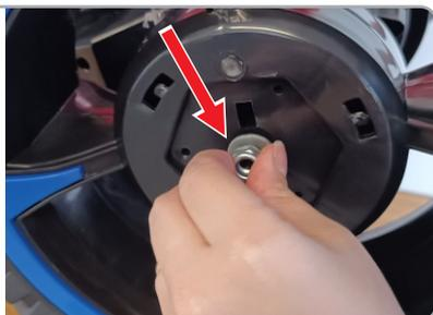
**1.2** Em cada lado do eixo, insira uma roda encaixando no mecanismo, uma arruela e uma porca.
