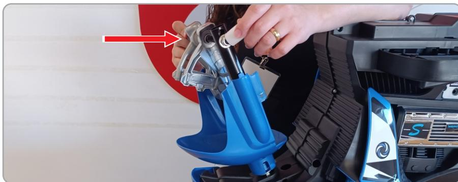
**1.4** Com as chaves plásticas, remova uma porca, uma arruela, os dois protetores do garfo e o eixo.
