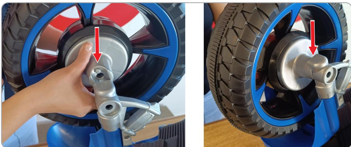
**2.0** Posicione a roda com as buchas no garfo, colocando o pino da bucha para cima conforme a ilustração. Encaixe-a no garfo, certificando-se de que o pino da bucha esteja encaixado no furo do garfo.
