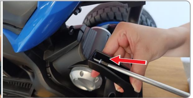
**1.0** Retire os dois parafusos da carroceria. Para facilitar a montagem posterior, insira cada parafuso nos respectivos escapamentos, conforme ilustração.
