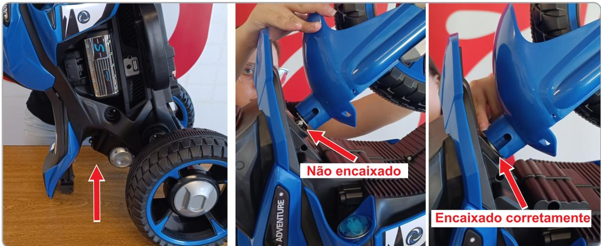
**1.0** Posicione a carroceria conforme a ilustração e encaixe totalmente o conjunto do garfo no corpo. Observe que o parafuso do garfo deve ficar completamente alojado na carroceria.
