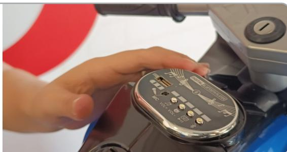
1.0 Encaixe o painel no alojamento e pressionando para que as travas fiquem totalmente encaixadas.
