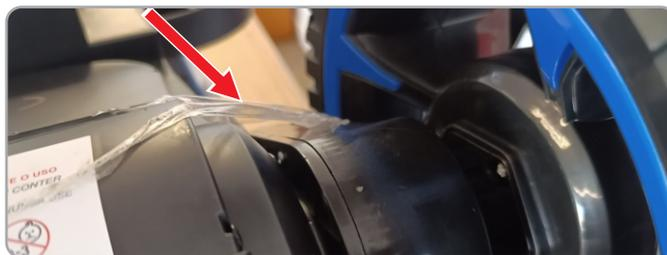
**1.5** Ao finalizar a montagem das rodas traseiras, a fita adesiva que prende os mecanismos poderá ser removida.
