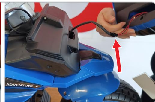
**1.1** Remova o parafuso do lado direito e do lado esquerdo da carroceria e reserve-os. Pegue a carenagem e conecte os plugs da carenagem aos plugs do corpo.
