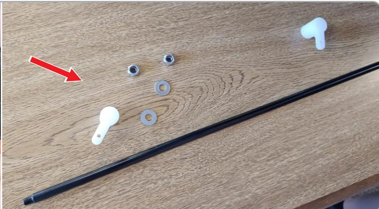
**1.0** Remova a abraçadeira plástica que fixa o eixo, e retire as porcas e arruelas do eixo com a chave plástica.
