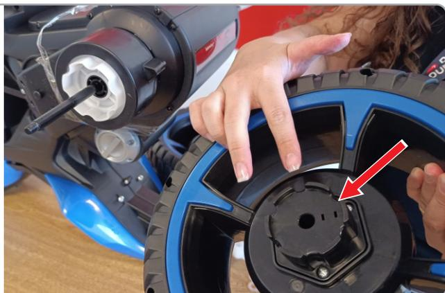
**1.1** Insira o eixo pelos furos do mecanismo e do corpo, e pegue uma roda traseira.
