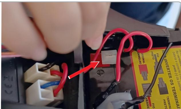
1.0 Pegue a chave de ignição da moto e gire a trava plástica para remover o assento. Retire a tampa plástica do terminal vermelho da bateria.
