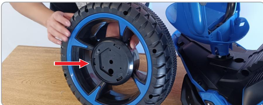
**1.8** pegue a roda dianteira, observando que ela tem a largura menor e não contém flange de encaixe.
