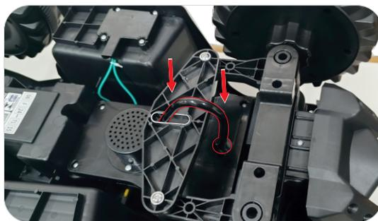
**1.0** Vire a carroceria com a parte inferior voltada para cima, insira e encaixe o eixo de direção na carroceria até que o eixo passe por todos os furos e encaixe a parte curvada no mancal de direção conforme a ilustração.
