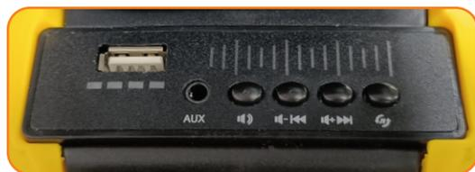
O painel multimídia conta com entrada USB, entrada auxiliar, seletor de música, controle de volume e indicador de bateria.
