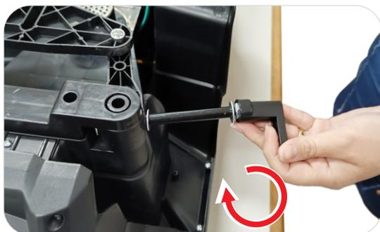
**1.4** Vire a carroceria com a parte inferior voltada para cima e, com a chave plástica, remova a porca do eixo dianteiro.
