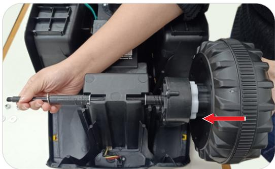
**1.8** Encaixe a roda no mecanismo.
