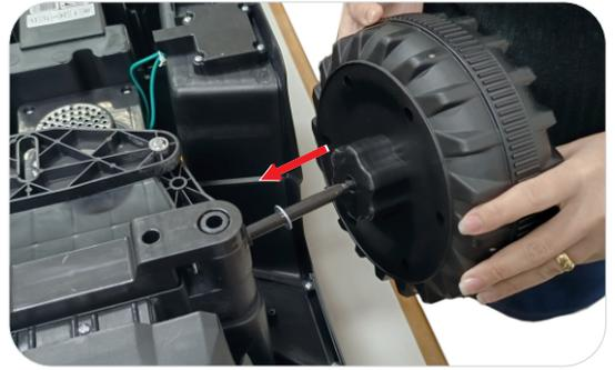
**1.5** Remova a porca e uma arruela, mantendo outra arruela no eixo. Em seguida, encaixe uma roda no eixo.
