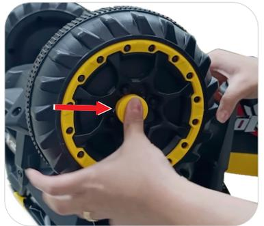
**1.7** Insira a calota, alinhe as travas nos alojamentos da roda e pressione firmemente para encaixar. Repita o procedimento com a outra roda dianteira.
