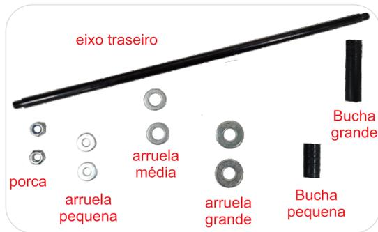
**1.0** Remova as abraçadeiras, Separe o eixo de direção para posterior montagem, remova as porcas, arruelas e buchas do eixo traseiro, e mantenha as peças organizadas para a montagem das rodas.
