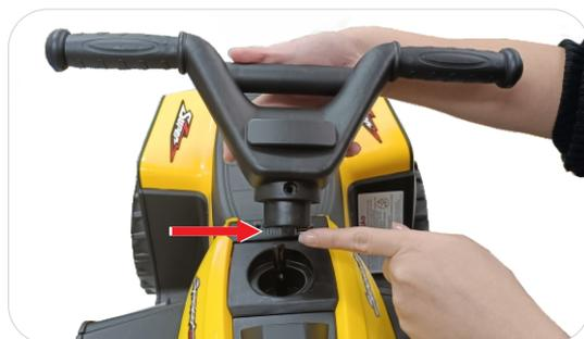
**1.2** Vire a carroceria para a posição normal de utilização, encaixe o guidão no eixo e na carroceria, mantendo a posição da trava limitadora voltada para frente.
