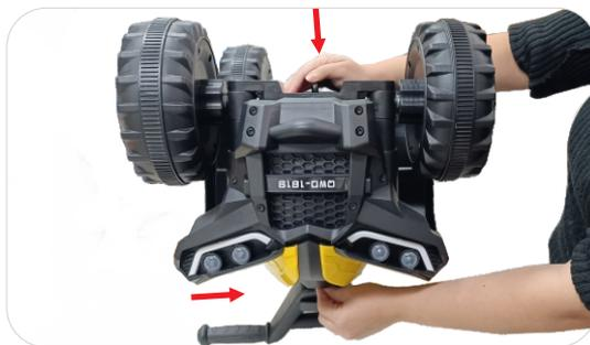
**1.3** Para maior facilidade, vire novamente a carroceria com a parte inferior voltada para cima. Alinhe as rodas e o guidão para que os furos fiquem alinhados, pressione o eixo de direção para baixo para facilitar o alinhamento.
