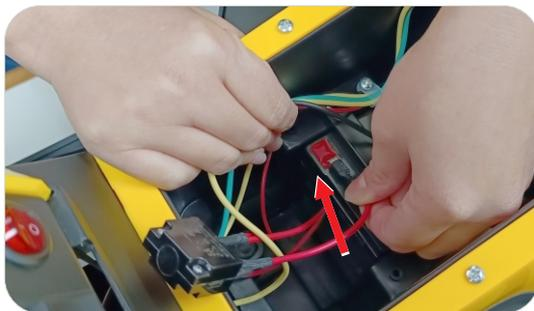
1.1 Retire a tampa plástica do **terminal vermelho** da bateria. Conecte o conector com o **fio vermelho** no **terminal vermelho (+)** da bateria.
