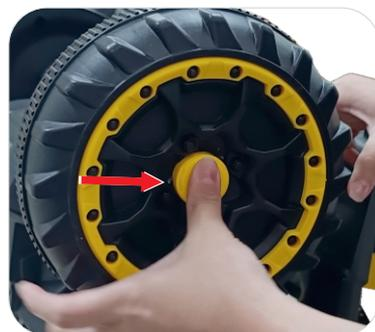
**2.2** Insira a calota, alinhe as travas nos alojamentos da roda e pressione firmemente para encaixar. Repita o procedimento com a outra roda.
