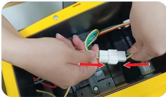
1.0 Vire a carroceria para a posição normal de utilização e conecte o plug do mecanismo ao plug da carroceria.
