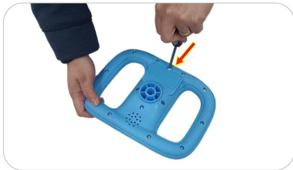
**1.2** Com uma chave Phillips, remova o parafuso e a tampa do compartimento das pilhas do volante.
