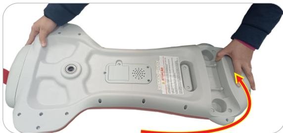
**1.0** Vire a carroceria com a parte inferior voltada para cima e posicione o conjunto das rodas traseiras na carroceria.
