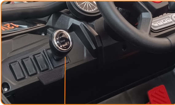
Alavanca com as posições: frente (Forward), ré (Back) e ponto morto(stop).
