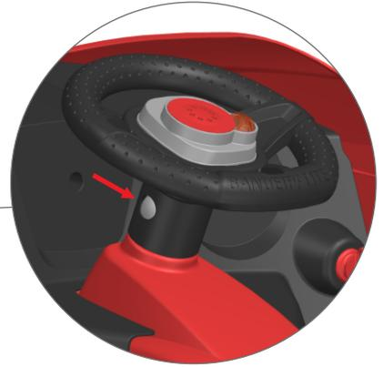
**2.0** Pegue o volante, posicione-o com a descrição "Bandeirante" voltada para o lado do motorista e, em seguida, encaixe-o no soquete até que as travas estejam alinhadas e encaixadas nos furos do volante.
