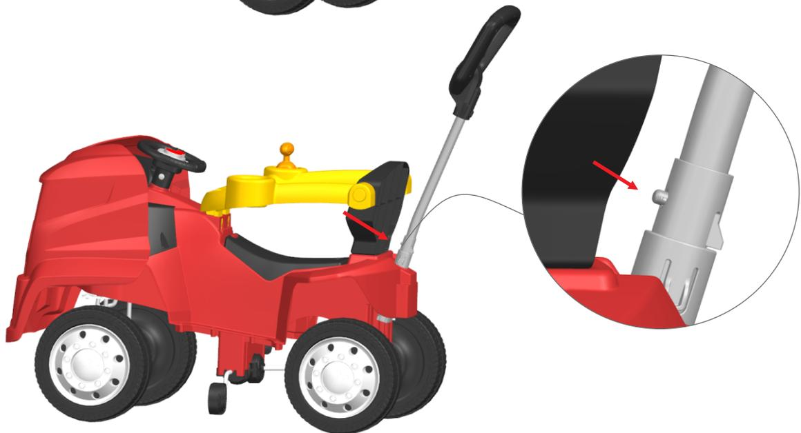
**4.0** Pegue a haste e posicione-a no suporte. Pressione o pino mola e encaixe a haste no suporte até que o pino mola fique encaixado no furo do suporte.
