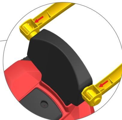
**3.0** Posicione os lados direito e esquerdo do cercado em seus respectivos lados.. Mantenha a parte inferior voltada para cima, para que o canal de alojamento fique alinhado com a trava do suporte do cercado e encaixe.
