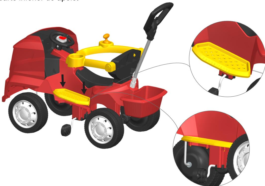
**6.0** Encaixe os apoios direito e esquerdo na carroceria, de forma que os pinos fiquem corretamente encaixados nos furos de alojamento. Certifique-se de que estejam bem fixados.
