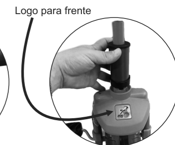
3 - Inserir o conjunto do garfo passando pelas buchas. Logo para frente
