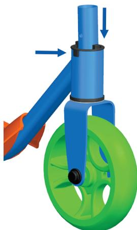
**1.5** - Insira a bucha com trava e encaixe-a na área superior do tubo do quadro (conforme ilustração).
