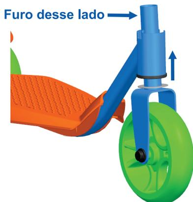
**1.4** - Insira o garfo com a arruela na área inferior do tubo do quadro e posicione o furo superior do garfo voltado para o lado interno.
