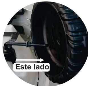
**1.2-** Insira uma roda dianteira no eixo e encaixe na bucha (conforme ilustração).
