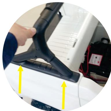
5.0- Encaixe as travas do santo antônio na carroceria (em ambos os lados) e pressione para encaixar (conforme ilustração) .
