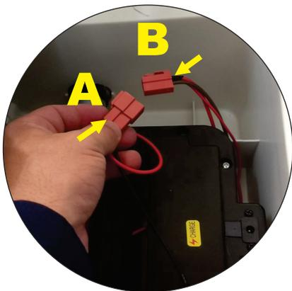
7.0- Conecte o plug A da bateria no plug B do módulo (conforme ilustração).
