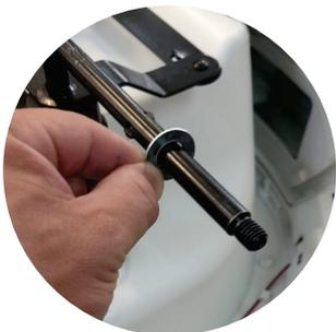
**1.0-** Posicione a área inferior da carroceria voltada para cima em uma superfície plana, forrada, firme e insira uma arruela no eixo dianteiro.
