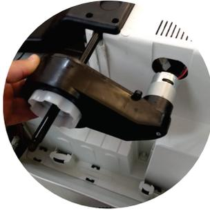
2.1- Posicione a área inferior da carroceria, voltada para cima, insira o mecanismo no eixo traseiro e conecte o plug.
