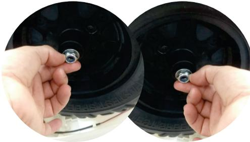
2.4- Repita os passos anteriores, para montagem do outro mecanismo e roda. Use uma chave de porca para apoiar a porca em um lado do eixo, enquanto a porca do lado oposto deve ser fixada com a outra chave (**certifique-se de que as rodas estejam bem fixadas**).
