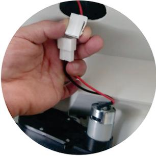
2.0- Desconecte o plug do mecanismo, localizado na área superior do corpo e retire o mecanismo.
