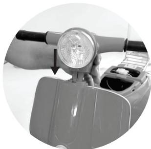
**1.5** - Encaixe o guidão no suporte e pressione para total encaixe.
