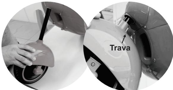
**1.2** - Insira o conjunto do garfo no corpo e encaixe a trava do para-lama no alojamento do corpo
