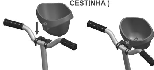
**4.1-** Com o suporte já encaixado no guidão (**conforme ilustração**) encaixe a trava da cestinha no suporte.
