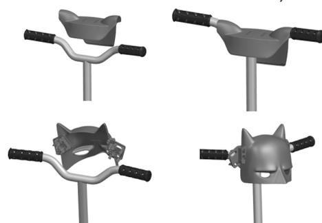
**5.1-** Encaixe a carenagem no guidão (**conforme ilustração**) e pressione para encaixar.
