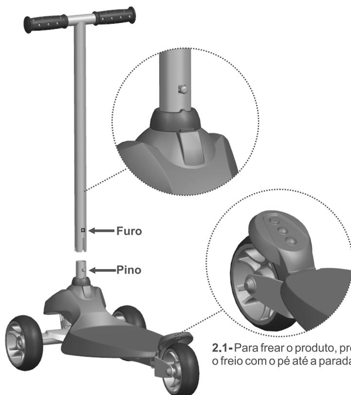
**1.1-** Insira a extremidade do guidão no quadro, alinhe e encaixe o pino da mola do quadro no orifício do tubo. Certifique-se de que as peças estão totalmente encaixadas.
