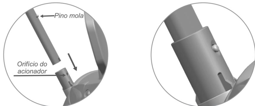
2.1- Encaixe o tubo da haste no acionador, localizado no corpo do produto, pressione o pino mola e encaixe no orifício do acionador. Certifique-se que a haste foi devidamente fixada. Para remover faça a operação inversa.
