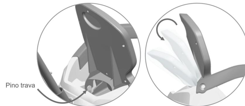
6.1 - O apoio de costas possui 3(três) posições de inclinação. Puxe o apoio de costas para cima, incline-o para efetuar o encaixe na posição desejada e encaixe no pino trava do corpo.
