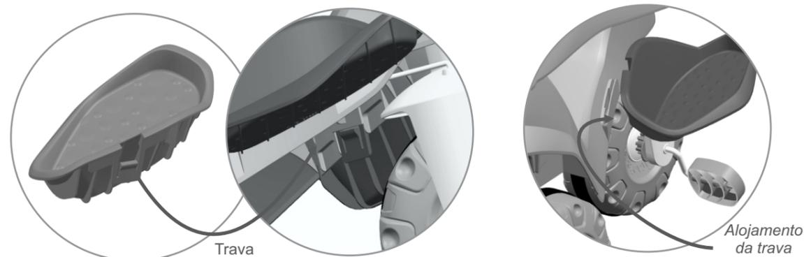
5.1 - **Remover o apoio dos pés (função pedal):** Pressione a trava do apoio (dir/esq) localizada na parte inferior do corpo do produto e remova.
