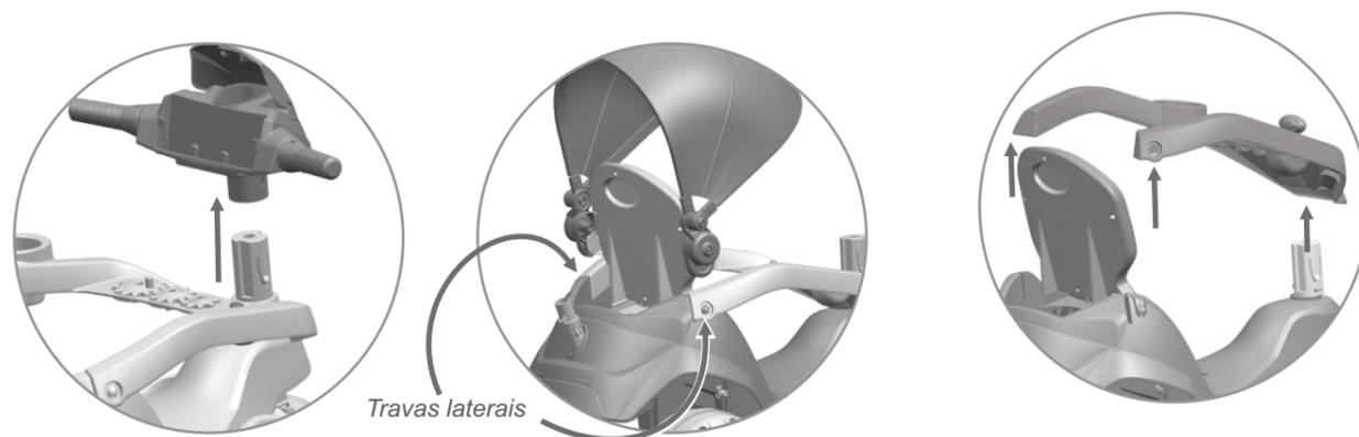
4.1- **Remover o cercado:** Primeiro remova o guidão, conforme mencionado na etapa 1.1. Pressione as travas da lateral do corpo do produto (conforme ilustração). Levante o cercado até que seja removido completamente. Para o encaixe efetue a operação inversa.
