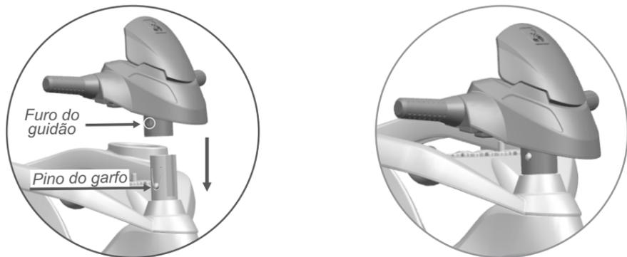
1.1- Insira o guidão na extremidade superior do garfo, pressione até o seu total encaixe. Certifique-se que o pino do garfo esteja devidamente encaixado no furo do guidão. Para remover, pressione o pino do garfo e remova o guidão.
